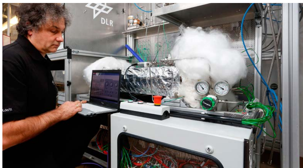
Der Wasserstoff-Tank ist mit Feststoffen gefüllt, die das flüchtige Gas wie ein Schwamm aufsaugen und besser im Tank halten.
