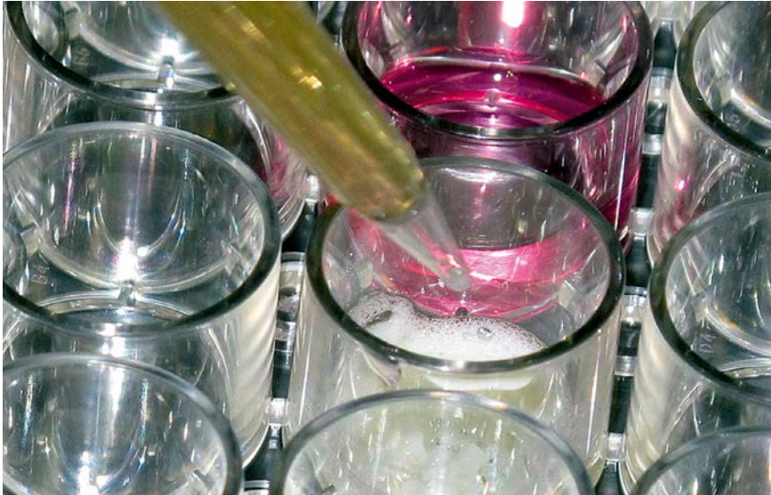
Ob und wie stark Substanzen antimikrobiell wirken, haben die Forscher in einem Screening untersucht. Das Knochenersatzmaterial wird dabei mit verschiedenen Bakterienarten versetzt. (Bildquelle: Fraunhofer IGB)
