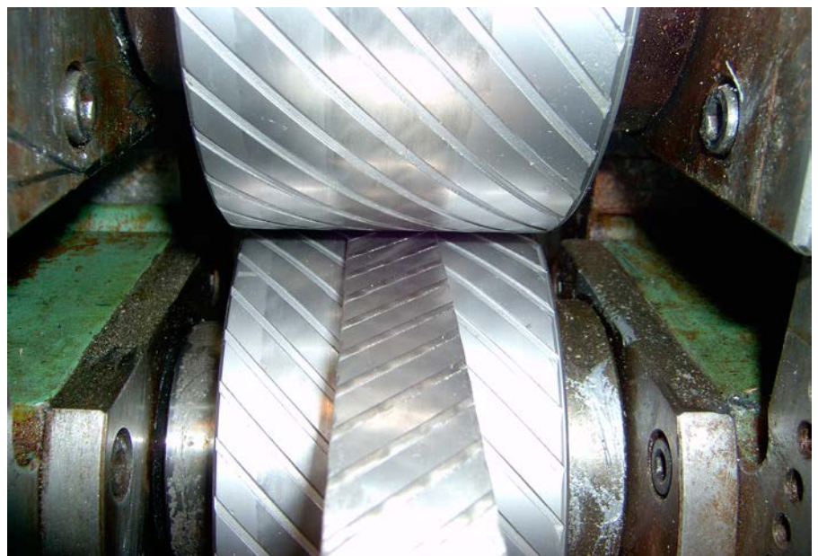
Herstellung einer gerippten Struktur durch Kaltpressen. (Bildquelle: Rau & Co.)
