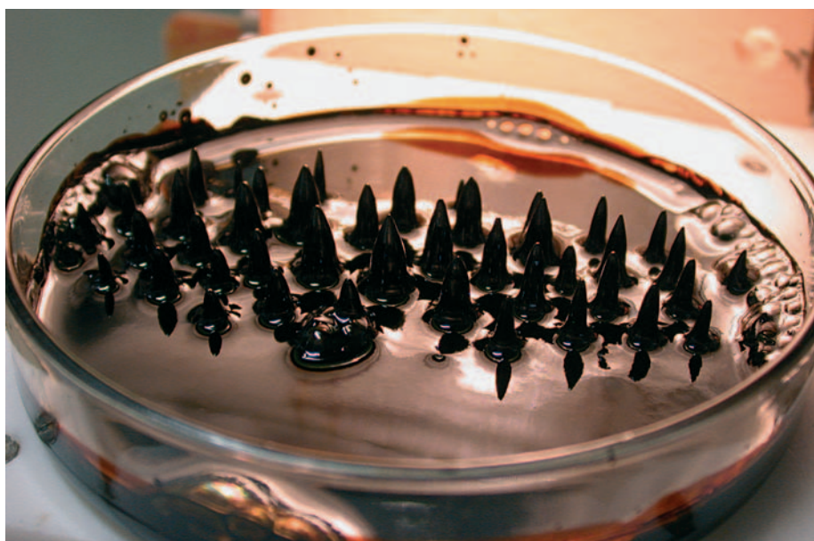
Bild 1: Durch Nanoferrite in einer Flüssigkeit lässt sich diese mit Magnetfeldern manipulieren
