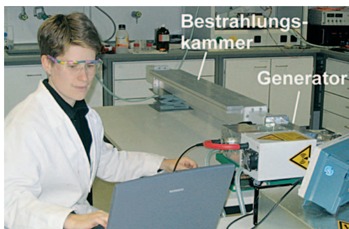
Bild 4: Laboraufbau zur Nanoferrit-unterstützten Mikrowellenaushärtung von Klebstoffen
